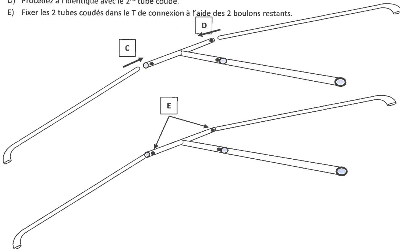
F) Positionnez l'assemblage que vous venez de réaliser, dans le support d'armature du toit, dans le panneau d'une des extrémités du chenil.
